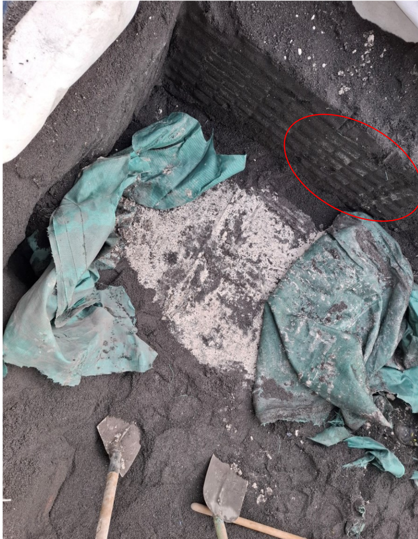
Figure 14 : Lit de Millisil® (blanc) déposé sous les caissons SAUL et la membrane géotextile de filtration, et mis au jour lors du démantèlement du système. L'ampleur de la migration horizontale Millisil® observée au-delà du géotextile le long des parois verticales reste minime (voir ellipse rouge).
