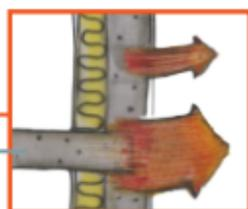
Appelés aussi nœuds constructifs, ce sont des endroits où il y a une rupture dans l'isolation. Cette rupture peut être due à un changement de matériau ou de son épaisseur. Ce sont des zones plus sensibles aux variations de températures et où le risque de condensation est plus important.
