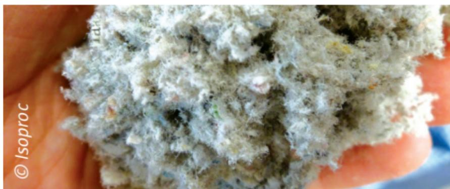
Produit à Achêne (Ciney), i3-cellulose est un matériau d'isolation écologique composé d'ouate de cellulose, celui-ci est insufflé directement dans les parois des bâtiments. Il est possible d'insuffler en compartiments, de souffler « ouvert » ou d'arroser, autant de techniques qui offrent une grande adaptabilité face aux contraintes du bâtiment.
